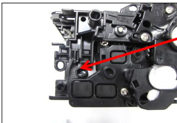
2. Зафиксируйте на корпусе картриджа контактную площадку совместимого чипа.
